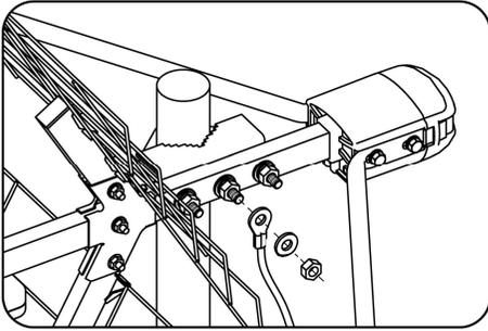
17. Установить антенну на мачте и присоединить провод заземления к винту заземления на узле крепления антенны (рис.15).
