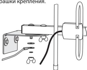
6.11 Зафиксируйте антенный кабель хомутом на кронштейне. Кабель должен иметь плавный изгиб от вилки SMA до места фиксации.
