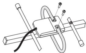
6.3 Для установки антенны возможно использовать два способа крепления: на стену или на мачту диаметром 25-52 мм. Выберите наиболее удобный способ крепления.
