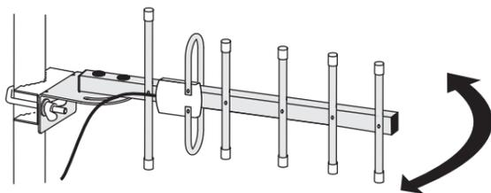
6.10 Подключите провод заземления к антенне. Затяните гайки-барашки крепления.
