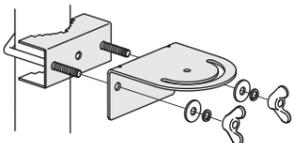
6.4 Закрепите антенну на кронштейне. Используйте винты М5 с квадратными подголовниками. Перед тем как накрутить гайки-барашки, установите обычные и стопорные шайбы.
