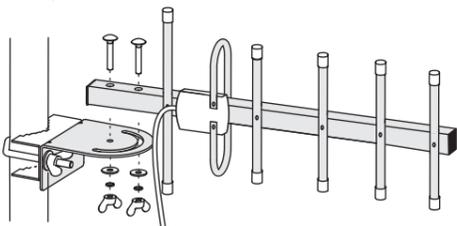
6.5 Просверлите отверстие диаметром 10мм в том месте, где антенный кабель должен попасть в помещение. Проташите кабель через отверстие. Минимальный радиус изгиба 50мм. При недостаточной длине основного кабеля используйте антенный удлинитель 5м.
