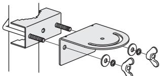
**5.4** Закрепите антенну на кронштейне. Используйте винты M5 с квадратными подголовниками. Перед тем как накрутить гайки-барашки установите обычные и стопорные шайбы.
