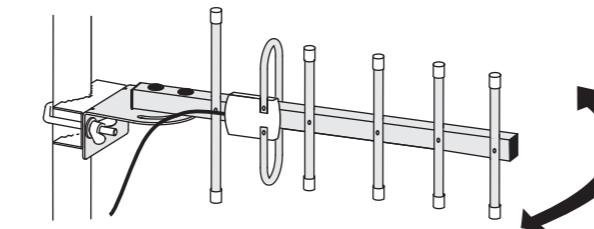
**5.12** Подключите провод заземления к антенне. Закрепите хомутом антенный кабель на кронштейне.
