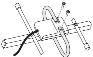
**5.3** Для установки антенны возможно использовать два способа крепления: на стену или на мачту диаметром 25-52 мм. Выберите наиболее удобный способ крепления.
