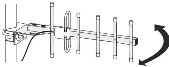
6.10 Подключите провод заземления к антенне. Затяните гайки-барашки крепления.
