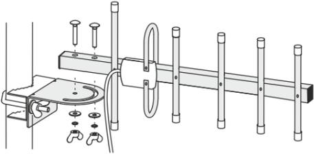
6.5 Просверлите отверстие диаметром 10мм в том месте, где антенный кабель должен попасть в помещение. Протачите кабель через отверстие. Минимальный радиус изгиба 50мм.
