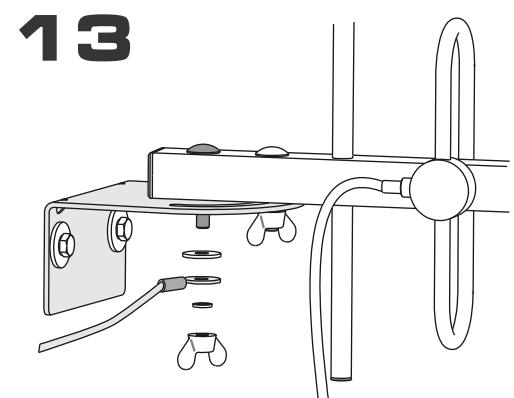
Подключите провод заземления к антенне.
