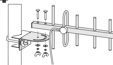
Закрепите антенну на кронштейне. Используйте Винты M5 с квадратными подголовниками. Перед тем как накрутить гайки-барашки установите обычные и стопорные шайбы.
