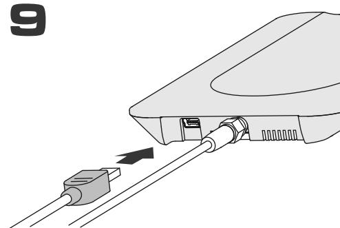
Подключите вилку USB провода источника питания к гнезду усилителя.
