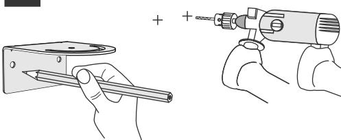
Приложите кронштейн к месту установки. Отметьте положение центров отверстий карандашом. Просверлите отверстия.
