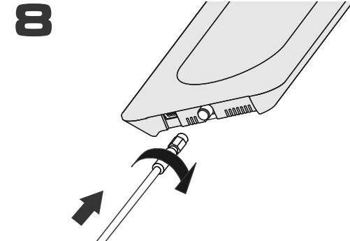
Подключите вилку SMA кабеля антенны к разъему усилителя.
