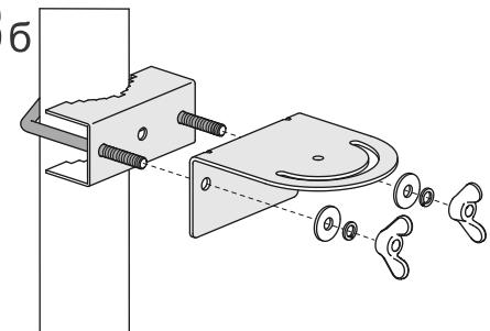
Для установки антенны на мачту закрепите кронштейн при помощи металлической скобы и П-образного кронштейна.
