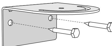
Для установки антенны на стену закрепите кронштейн при помощи шурупов. Если стена из кирпича или бетона, то в просверленные отверстия установите дюбели.
