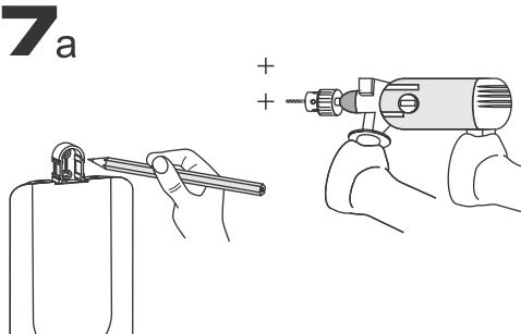
Приложите корпус к месту установки на стене. Отметьте положение центров отверстий карандашом. Просверлите отверстия.
