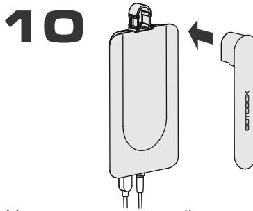
Установите антенный элемент усилителя. Вставьте в направляющие до упора.
