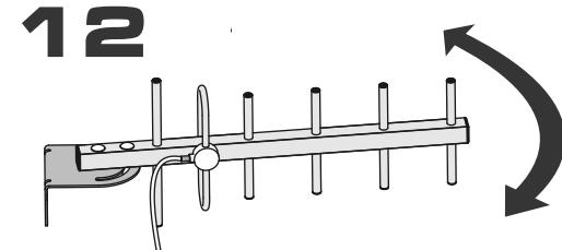
Настройте направление антенны. Поворачивайте antennу на угол 10-15 градусов с задержкой в 30 секунд и проверяйте уровень сигнала на телефоне внутри помещения. Так Вы найдете оптимальное направление антенны.
