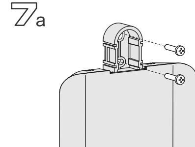
Закрепите корпус усилителя при помощи самонарезающих винтов. Для крепления на кирпичную или бетонную стену установите в просверленные отверстия дюбели.
