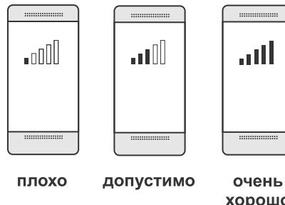
Определите наилучшее место для установки внешней антенны с помощью индикатора на вашем телефоне.
