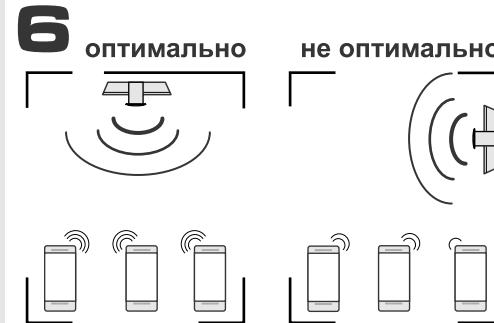
Определите наиболее благоприятное место установки усилителя SOTOBOK в помещении для обеспечения наилучшей зоны охвата.
