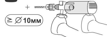
Просверлите отверстие Ø 10 мм в том месте стены, где кабель должен попасть в помещение. Протащите кабель от антенны через отверстие. Минимальный радиус изгиба кабеля 50мм.
