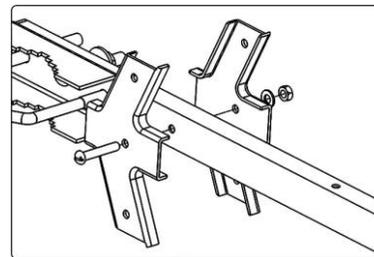
**2** Закрепить на штанге держатель стоек рефлекторов **винтом №2**. Гайку до упора **не затягивать**.
