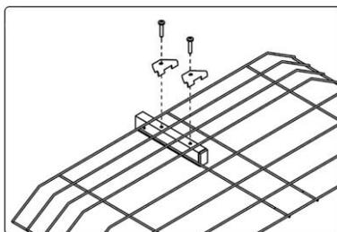
8 Сборка рефлекторов и установка их в держатель рефлекторов на штанге:
