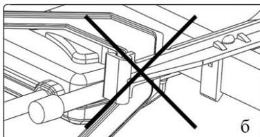
**!** Не допускается при установке кронштейнов на штангу менять их ориентацию (разворачивать на 180° см. рисунок (б)), это приведет к ухудшению характеристик антенны и как следствие к ухудшению приема телевизионного сигнала.
