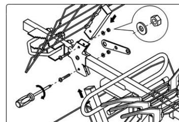
Таким же образом собрать и установить второй рефлектор. Окончательно затянуть центральный винт с гайкой и шайбой держателя стоек рефлекторов.
