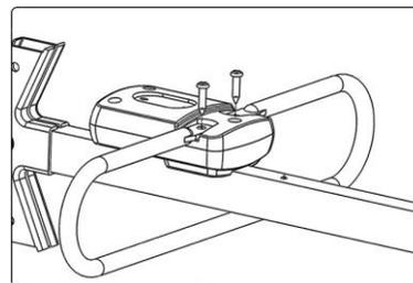
**4** Установить петлевой вибратор, вставив его плоские концы в пазы монтажной коробки и закрепить винтами.
