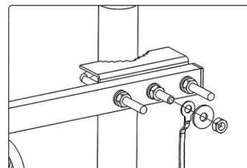
9 Установить антенну на мачте и присоединить провод заземления к узлу крепления антенны. Сориентировать антенну на телецентр по наилучшему качеству изображения на экране телевизора. Окончательно зафиксировать антенну.
