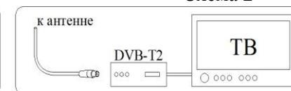
После подключения кабеля к телевизору (см. схему 1) или цифровой приставке (см. схему 2), следует включить подачу питания +5В на цифровую антенну от телевизора или цифровой приставки. подача питания +5В включается согласно руководству по эксплуатации телевизора или цифровой приставки DVB-T2.
