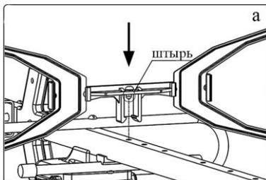
7 Установить последовательно 14 кронштейнов с установленными директорами на штангу ориентируя их согласно рисунку (а). При этом обеспечить совпадение базового отверстия на штанге с посадочным штырем нижнего паза кронштейна.
